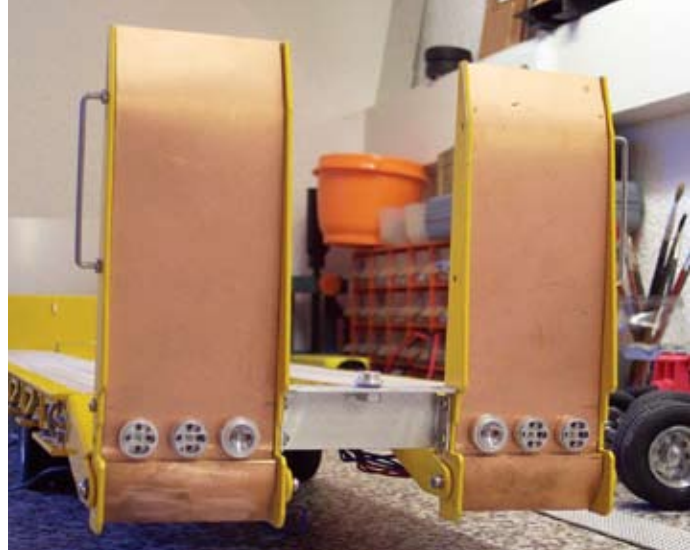
Mit Platine und neuen Rücklichtern wurden die Rampen neu gestaltet
