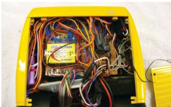
Akku, BEC, Fahrregler, Soundmodul SMT, Empfänger, Relais, Multiswitch, Zeitschloss, Blinker- und Bremslichtplatine befinden sich sortiert im Führerhaus
