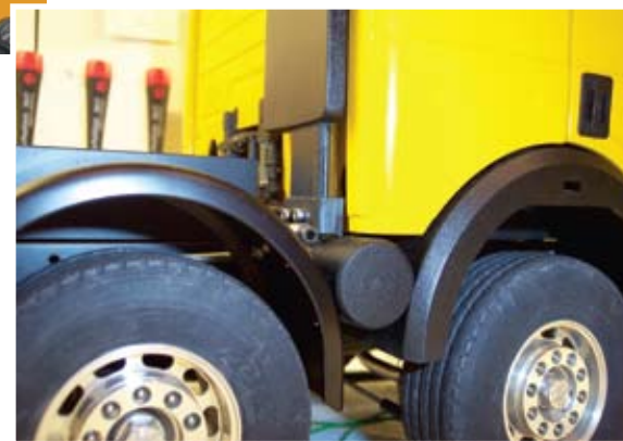
Am Frischluft-Schnorchel wurde unten eine Luftfilter-Attrappe nachgebildet
