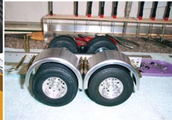
Einzelkotflügel während der Erstmontage an die Messinghalter
