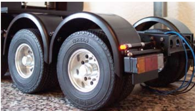
In die hinteren Kotflügelhalter sind orangene LEDs eingelassen
